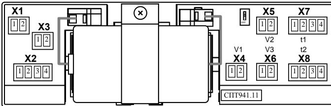
Рисунок 10.1 – Размещение гнезд для подключения внешних цепей
