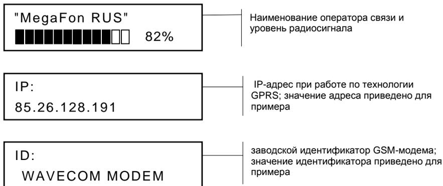
Рисунок 5.8 – Информация, выводимая на табло в режиме НАСТР-ТСТ-МОДЕМ-GSM.
