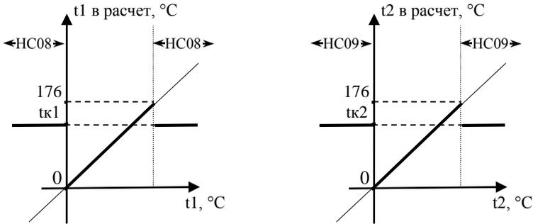
Рисунок 7.3 – Контроль температуры и условия использования констант
