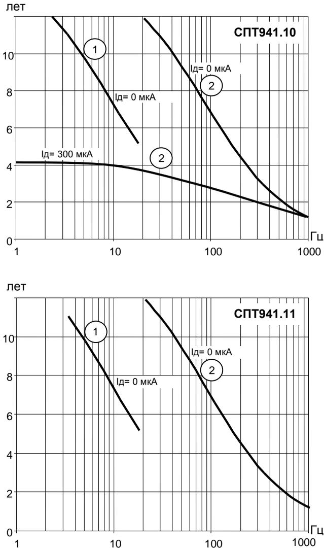
Рисунок 2.1 – Зависимость ресурса батареи (лет) от частоты входных импульсов (Гц) и суммарного среднего тока потребления преобразователей объема  $I_d$ .
