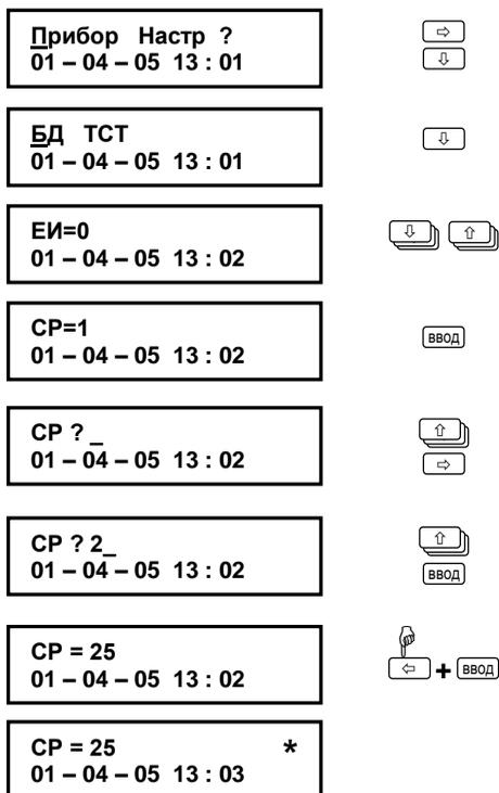
Рисунок 5.6 – Ввод числового значения параметра СР=25
