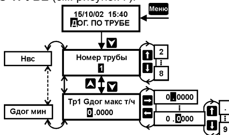
Рисунок 7 – Установка договорных параметров по трубопроводам
