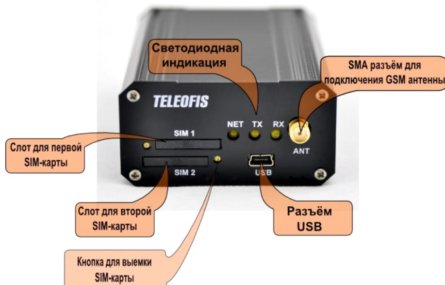
Рис. 4: Внешние разъёмы устройства. Сторона 2.
